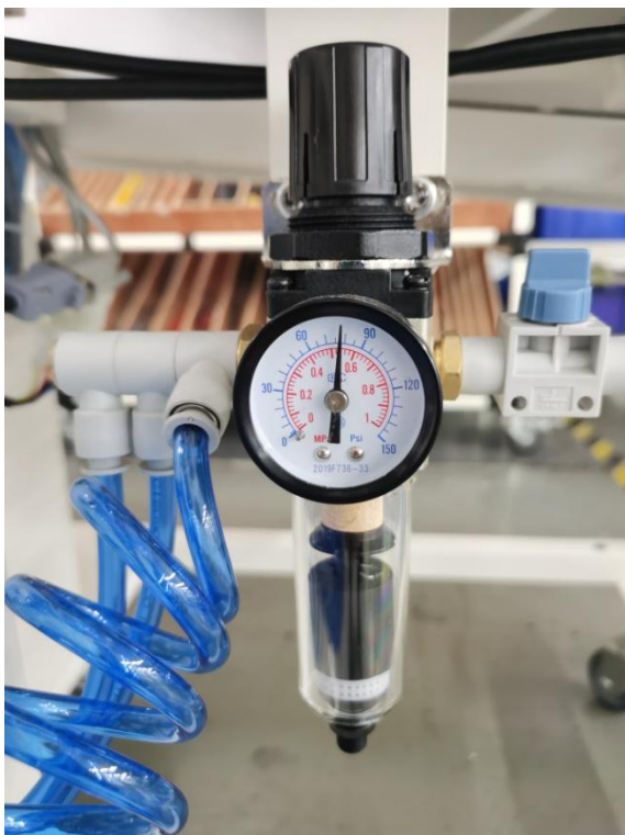
其余气控元件由此气压表控制，出厂设置 0.5 MPa
