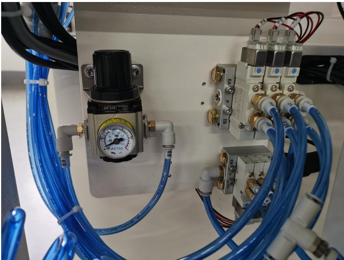
此气压阀是控制送料组的，出厂设置 0.05MPa
